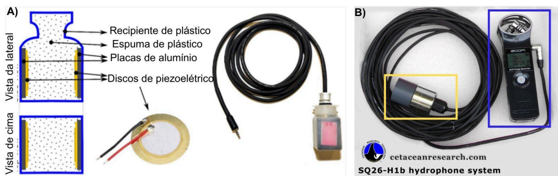
Figura 6. Esquema do hidrofone com detalhes de suas partes em A e um exemplo comercial do hidrofone com gravador em B. A) Composição do hidrofone e suas partes (Adaptado de: DE MARCO, Rocco et al. 2023). B) Exemplo disponível no mercado do hidrofone (amarelo) conectado a um gravador (azul) (Disponível em: cetaceanresearch.com ).
